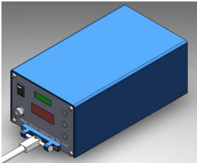
CNE-6002-BP 用于板坯结晶器锥度测量。与传统的锥度仪相比，CNE-6002-BP 具有示数直观、操作简单、体积小、重量轻等优点。CNE-6002-BP 采用进口倾角传感器，具有良好的重复性和极低的迟滞。工业级温度范围，高线性度，低温漂可以保障在工业现场获取可靠的数据。CNE-6002-BP 电路全部采用进口工业级器件，良好的温度稳定性和高可靠性保障设备低故障长寿命工作。电路板采用 SMT 工艺加工，具有可靠性高、抗振能力强、焊点缺陷率低、高频特性好等特点，强力保障整机出厂的一致性，减少了电磁和射频干扰。数据处理部分采用 ARM Cortex-M4 内核 MCU，MCU 内置了 DSP 数据处理单元，采用 FFT 算法滤波极大的降低了震动及信号串扰引入的误差。
